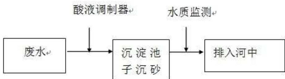
图 8.2 混凝土拌和系统废水处理流程图
