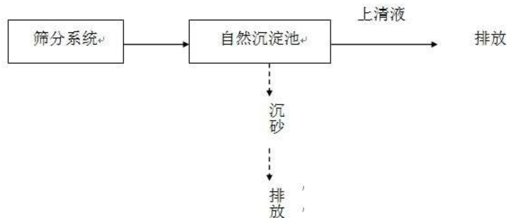
图 9.1 自然沉淀法处理流程图
