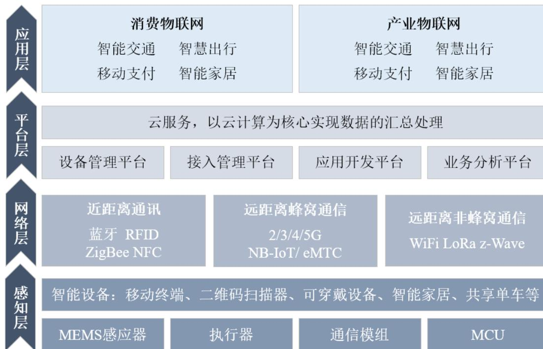
感知层实现对物理世界的智能感知识别、信息采集处理和自动控制，并通过通信模组连接到网络层。网络层通过不同的通信协议将感知层采集到的信息向平台层传输。平台层是数据的汇总和处理中心，在物联网体系中起到承上启下的作用，主要包括设备管理平台、接入管理平台、应用开发平台及业务分析平台等。
